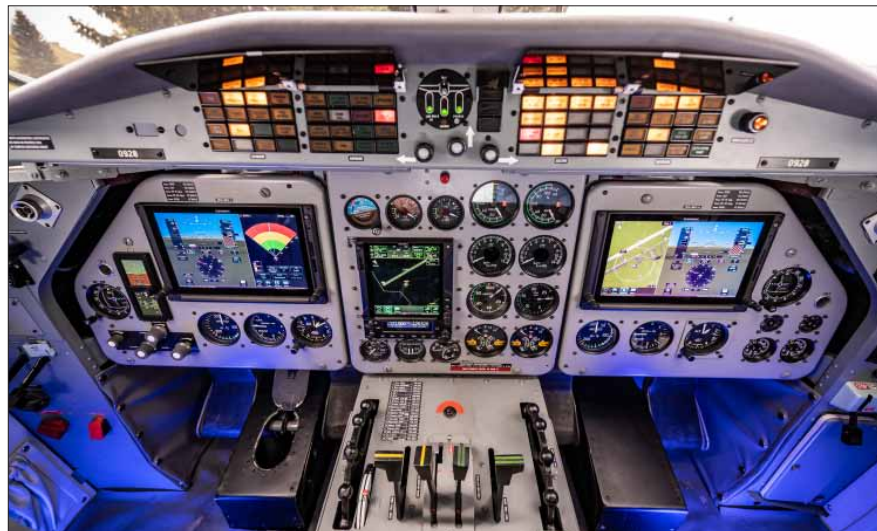
Nejdůležitějším prvkem je zástavba systému Garmin G700TXi s dvěma velkoformátovými displeji GDU 1060
