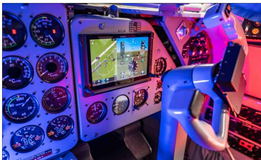
Nejdůležitějším prvkem je zástavba systému Garmin G700TXi s dvěma velkoformátovými displeji GDU 1060
